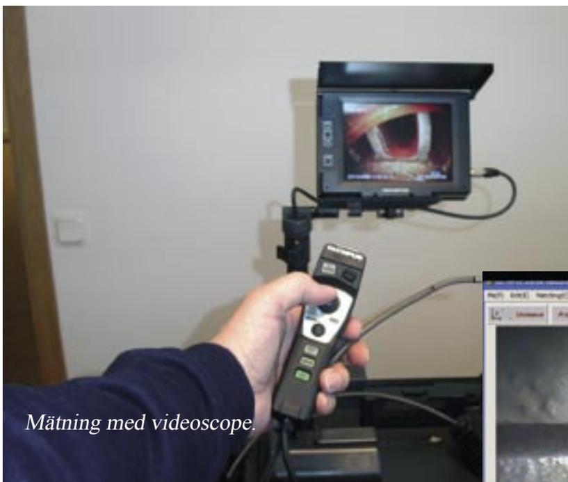
Mätning med videoscope.
