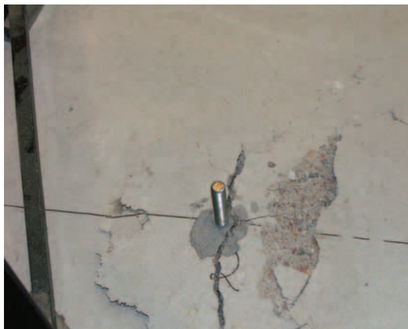
Utdragsproverna på SP visade att kemankaret alltid hade högre styrka än betongen
